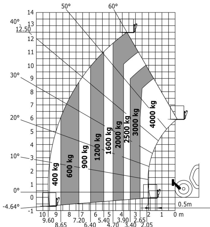
Rotación sobre estabilizadores bajados, con horquillas
